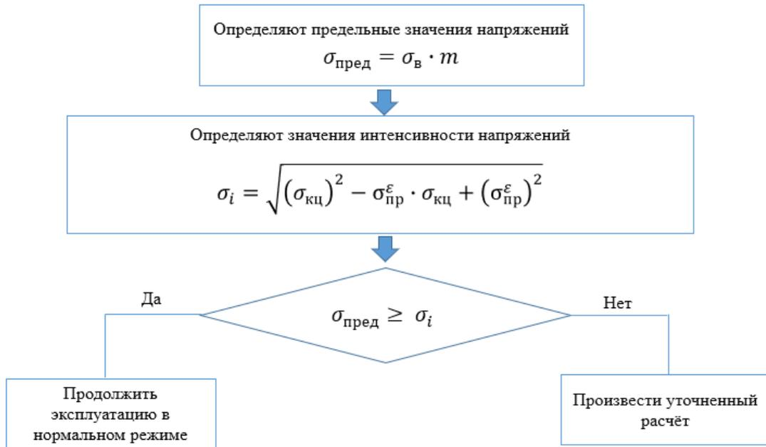
Рисунок 4.14 – Схема первичной оценки предельно допустимого состояния участка подземного трубопровода
