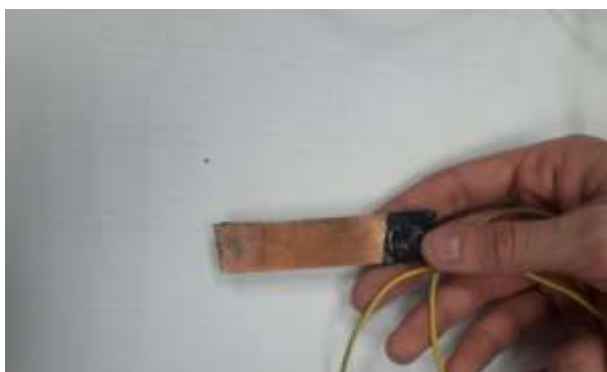
в) Медь ( \rho_{\text{медь}}=1,7 \cdot 10^{-8} \text{ Ом} \cdot \text{м} )
