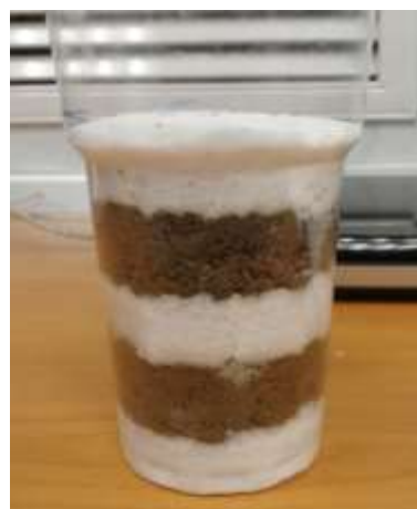
Рисунок 3.9 – Схема укладки слоев соли и песчаного грунта вокруг заземлителя
