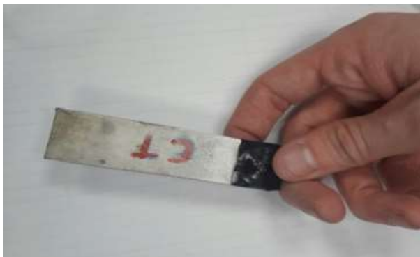
а) Сталь ( \rho_{ст}=13 \cdot 10^{-8} \text{ Ом} \cdot \text{м} )
