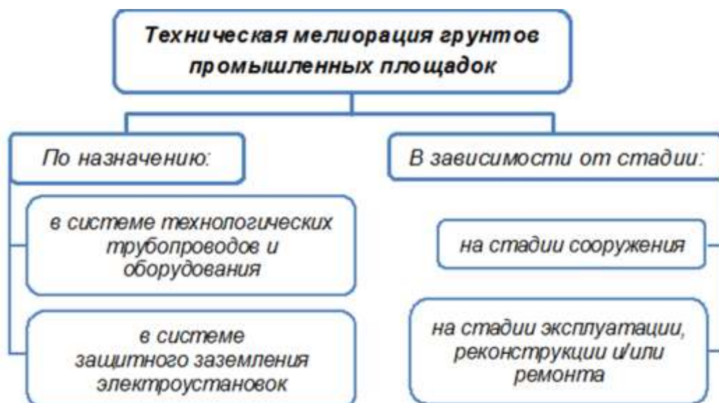
Рисунок 1.4 – Техническая мелиорация грунтов ПП
