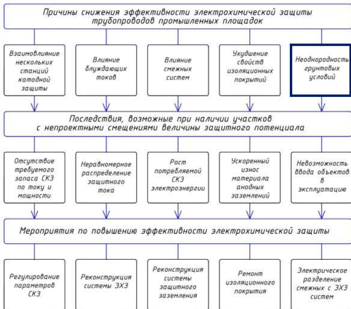
Рисунок 1.2 – Классификация причин и возможных решений проблемы защищенности участков трубопроводов от коррозии
