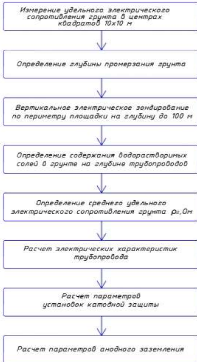
Рисунок 4.1 – Алгоритм проектирования электрохимической защиты площадных объектов КС, НПС, ГРС
